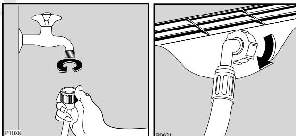
Другой конец наливного шланга, подключающийся к машине, может быть повернут в любом направлении. Ослабьте гайку, поверните шланг и вновь затяните гайку, проверив отсутствие течей воды. Наливной шланг нельзя вытягивать. Если он слишком короткий, и вы не хотите передвигать кран, то
